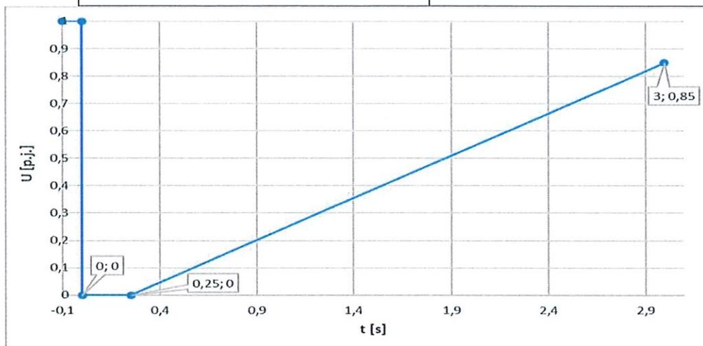
V prípade nesymetrickej poruchy platia rovnaké krivky ako v prípade poruchy symetrickej.
